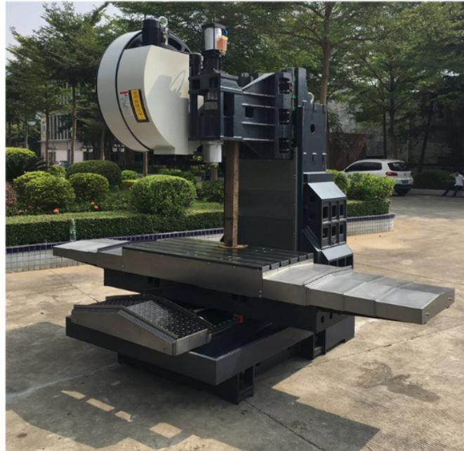
加工中心常按主轴在空间所处的状态分为立式加工中心和卧式加工中心，加工中心的主轴在空间处于垂直状态的称为立式加工中心，主轴在空间处于水平状态的称为卧式加工中心。主轴可作垂直和水平转换的，称为立卧式加工中心或五面加工中心，也称复合加工中心。按加工中心立柱的数量分为单柱式和双柱式（龙门式）。按加工中心运动坐标数和同时控制的坐标数分为：三轴二联动、三轴三联动、四轴三联动、五轴四联动、六轴五联动等。三轴、四轴是指加工中心具有的运动坐标数，联动是指控制系统可以同时控制运动的坐标数，从而实现刀具相对工件的位置和速度控制。
